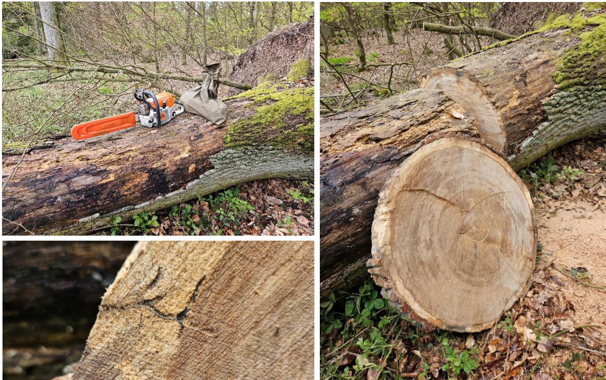
Abbildung 2: Welche Holzqualität hätten Sie dieser Traubeneiche noch zugetraut? Die ca. 120-jährige Eiche stand mindestens fünf Jahre trocken im Bestand bis sie nach einem Sturm ein weiteres Jahr liegend im Wald verblieb. Die herausgeschnittene Baumscheibe zeigt bestens die außerordentliche Haltbarkeit dieses Baums: Während das Splintholz (heller) durch Witterung, Käfer und Vögel beschädigt wurde, ist das wertvolle Kernholz (dunkel) vollkommen unbeeinträchtigt.
